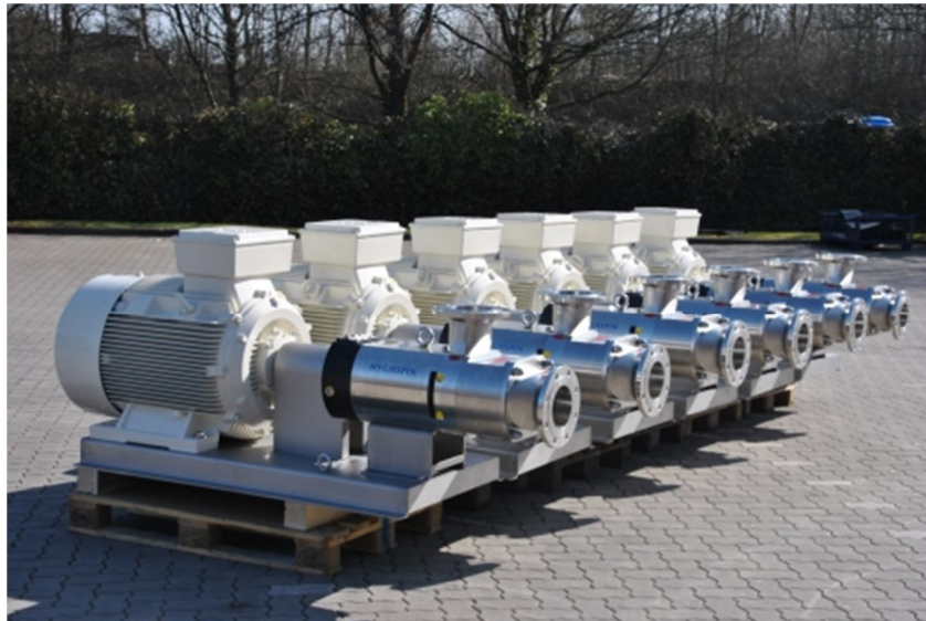
Sechs HYGHSPIN 125-Pumpen für einen der weltweit größten Verarbeiter von Zitrusfrüchten
